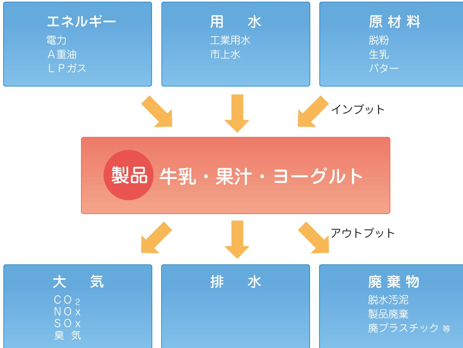
通常工場は、エネルギー、水、原材料を投入して製品をつくり、産業廃棄物を排出しますが、当社のバイオマスプラントは、廃棄製品・汚泥をバイオガス化することにより、廃棄物を減容して尚、使用エネルギーを減容する為の試みです。
